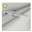
Positionieren Sie den Sicherungsclip und drücken Sie ihn in Richtung Halterung.
