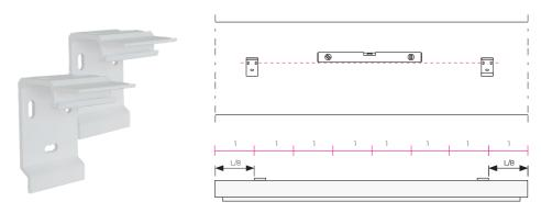
Um die Halterungen richtig am Gehäuse zu montieren, teilen Sie die Länge der Leinwand in 8 Teile. Achten Sie bei der Montage darauf, dass die Halterungen ausgerichtet sind und bohren Sie die Löcher in die Halterung; die Halterungen können sowohl an der Wand als auch an der Decke montiert werden.
